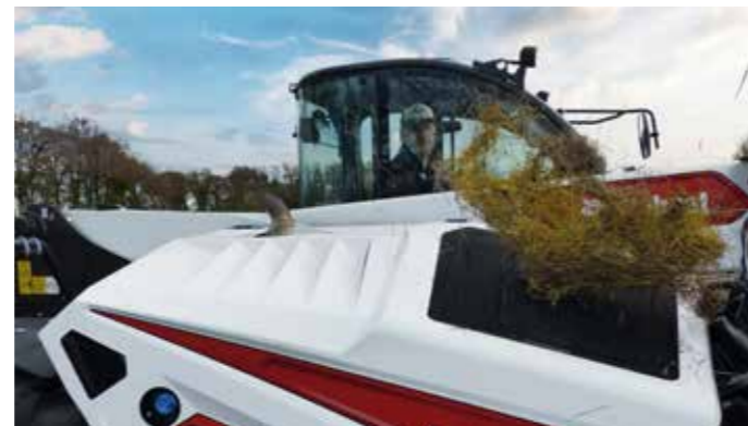
Ventilateur réversible avec modes manuel et auto
