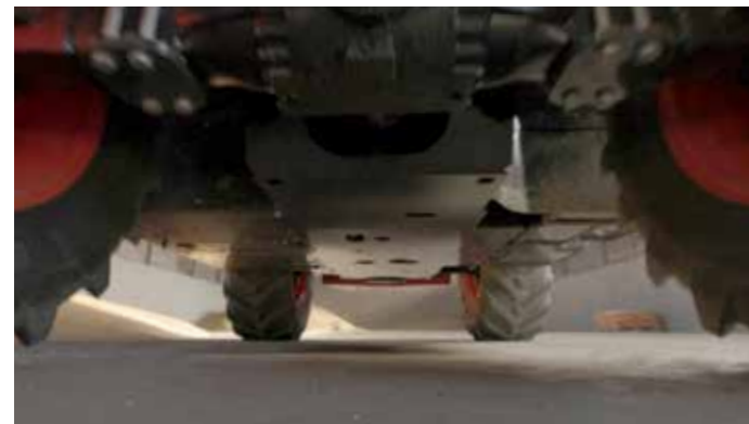
Plaque de blindage sous le châssis
