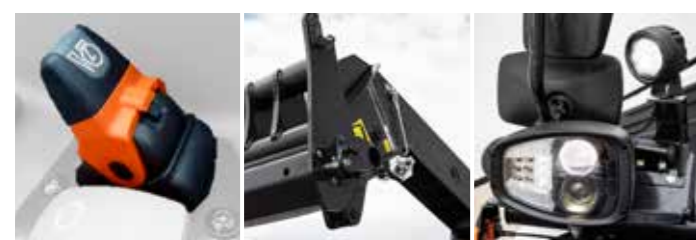
Accélérateur manuel et entraînement Flex Verrouillage hydraulique des accessoires via une conduite auxiliaire dédiée Pack d'éclairage routier LED : • feux de route • gyrophare • feu de recul
