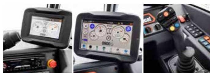
Écran de 5" standard avec radio Bluetooth, microphone et haut-parleurs Écran tactile de 7" (radio Bluetooth avec microphone et Job Manager) Manipulateur Smart
