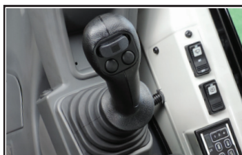
Joysticks à commande hydraulique
